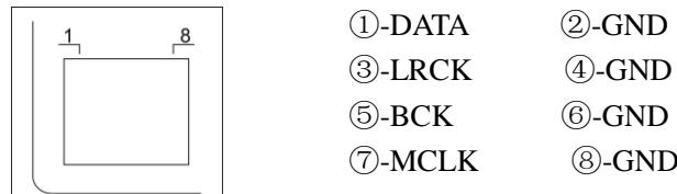
**注:** 自制 IIS 连接线时建议用超 5 类双绞网线, 每一条信号线与一条 GND 双绞在一起, 同时 I2S 线长建议不超过 50CM.
